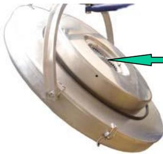
Mit Bürste oder mit Druckluft reinigen.
